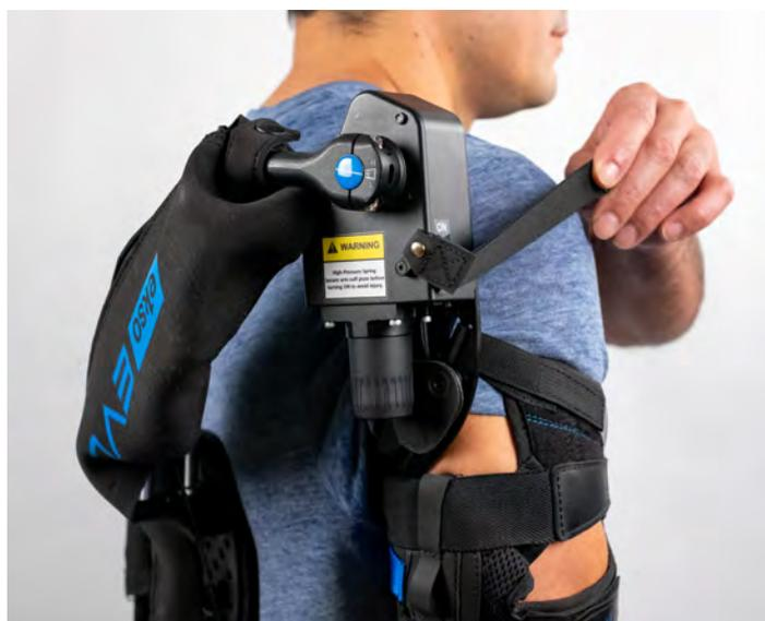
**Figure 14: Turning Ekso EVO On**
